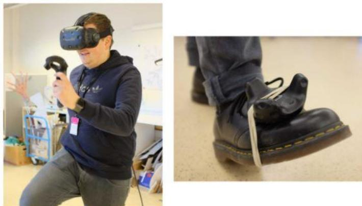
*Figure 10 : Utilisateur se déplaçant avec le système de marche sur place [7].*
